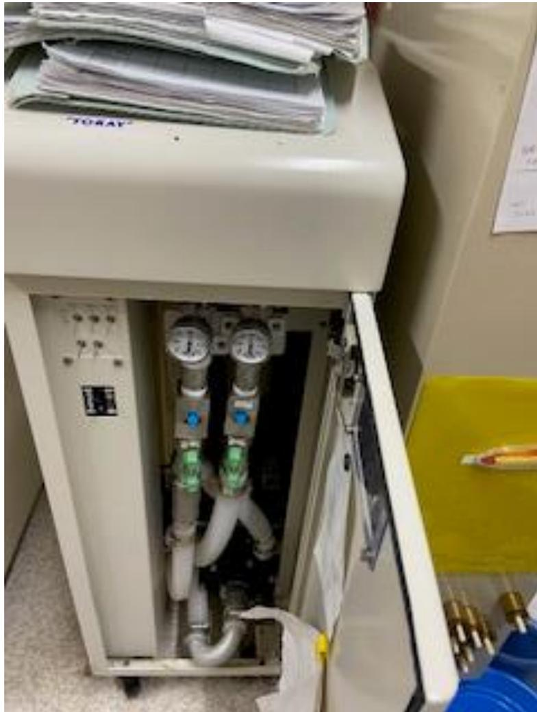
透析液供給装置直後に設置して透析液中のエンドトキシン、パイロジェンを除去、2年に1回交換します。
